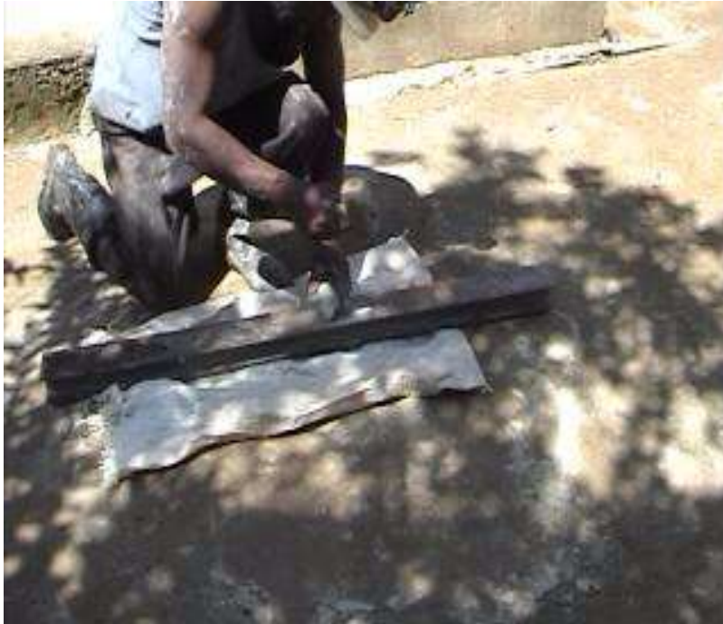
Foto No 18 trituración de mineral MENA mina la favorita vereda el desquite.
