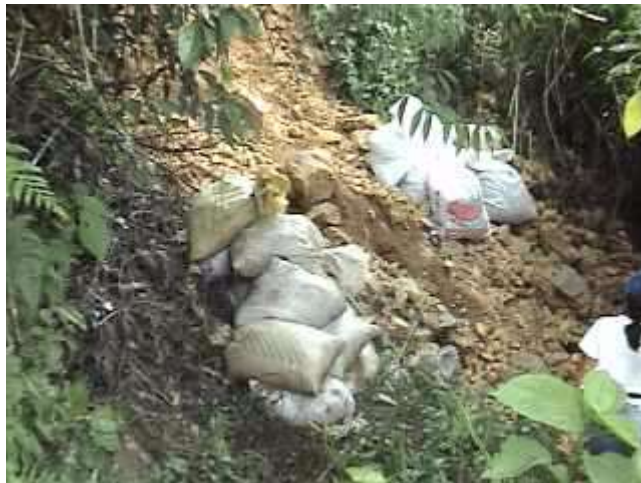
Foto No 13 carga de mineral en bultos de 50 a 70 Kilos para trituración.
