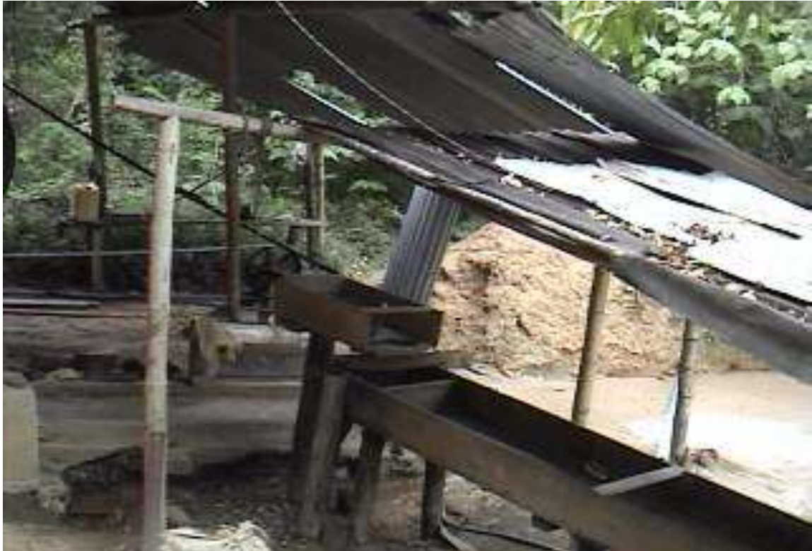
Foto No 26 laberinto o canalón para concentrar oro después de un proceso de trituración y molienda en todas las plantas visitadas.
