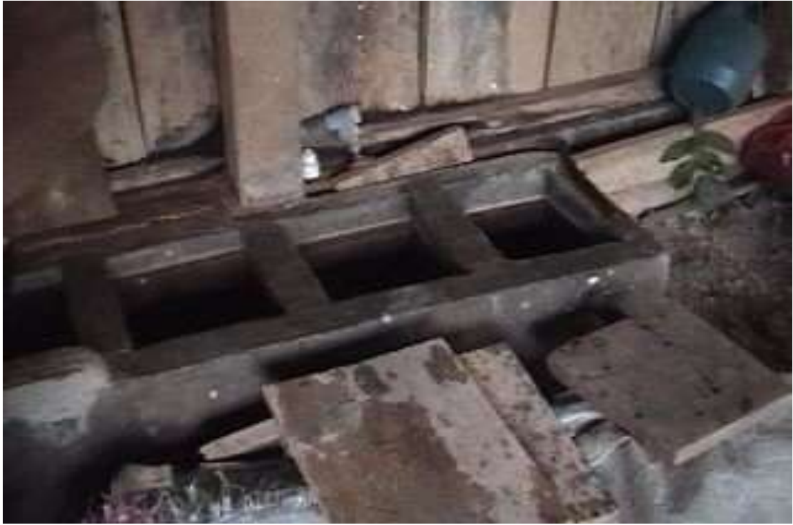
Foto No 28 Cajas de precipitación oro en un proceso de cianuración, planta los Acosta, vereda el Tamboral.
