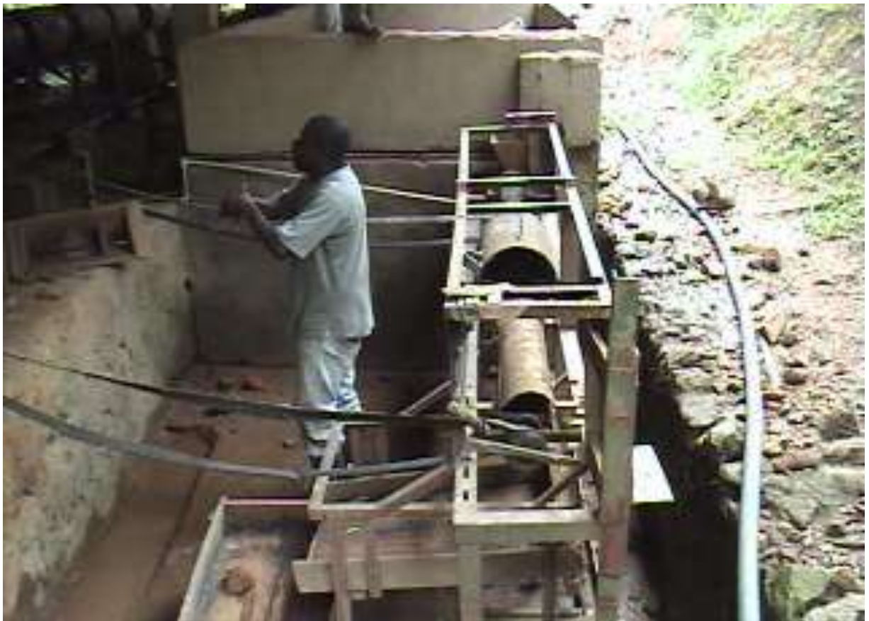
Foto No 35 concentración gravimetrica mecanizada planta de trituración y molienda el Carmán
