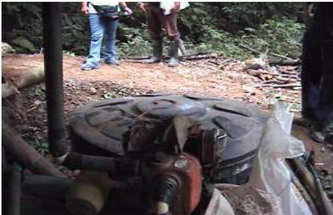
Foto No 27 tanques para recircular solución cinurada, planta los Acosta, vereda el Tamboral.
