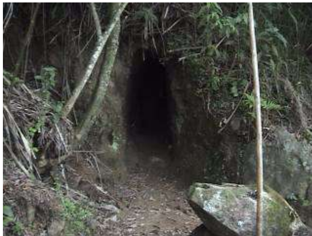
Foto No 02 Bocamina típica de minería subterránea.
