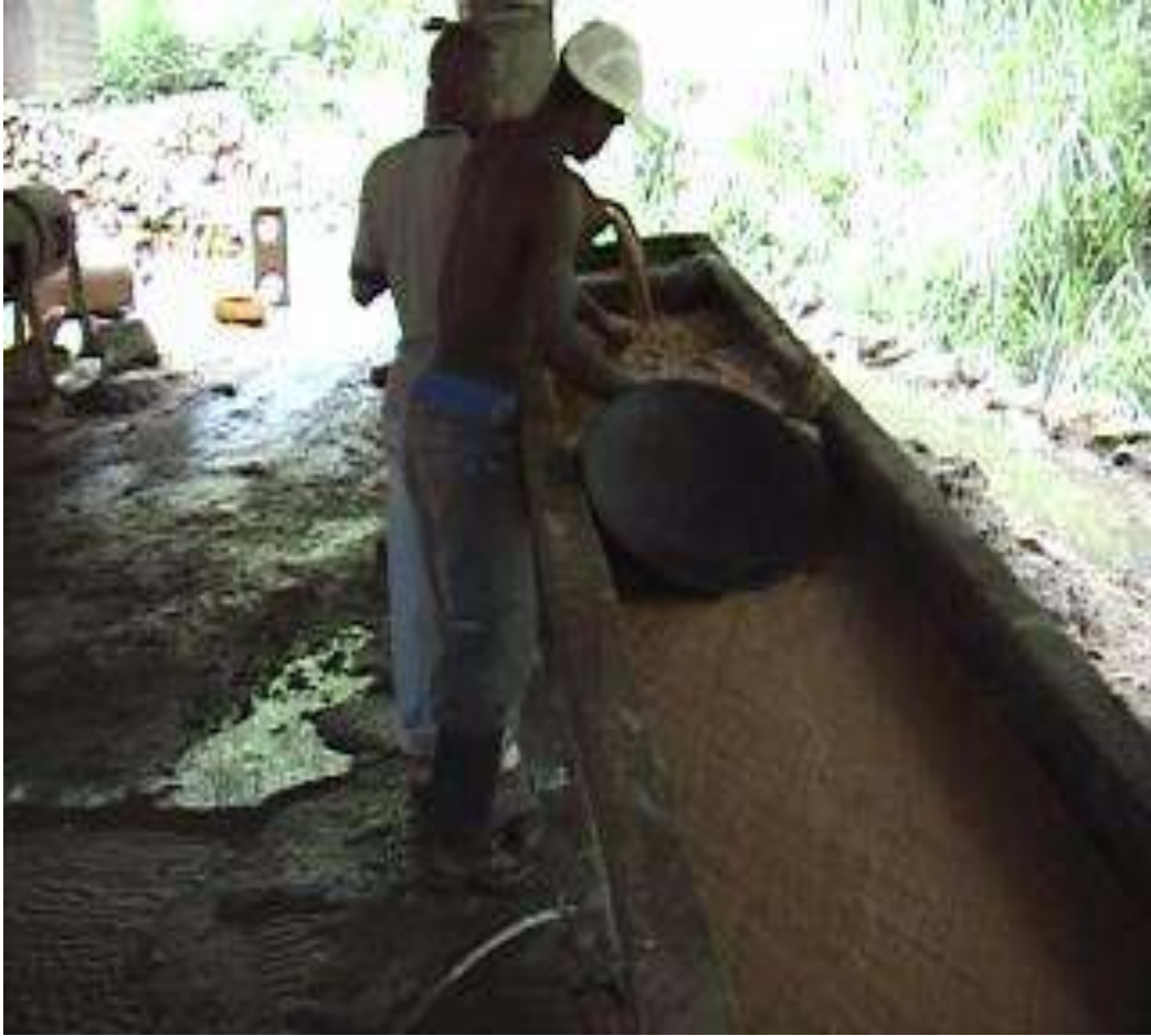
Foto No 36 concentración gravimétrica en canalón en las plantas de la región corregimiento de Mindala y la Toma .
